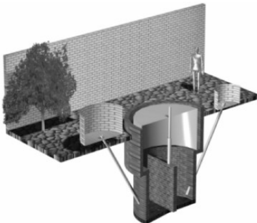
Figura 2: Corte tridimensional do biodigestor modelo indiano.
